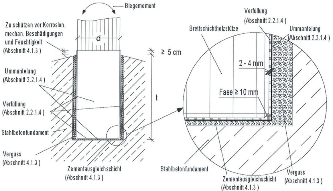
Stützen aus Brettschichtholz zur Einspannung durch Verguss in Stahlbetonfundamente
