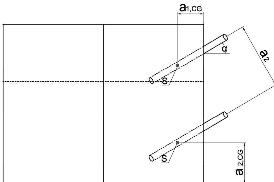
S: Schwerpunkt des im Holzbauteil eingeklebten Teiles der Stahlstäbe
