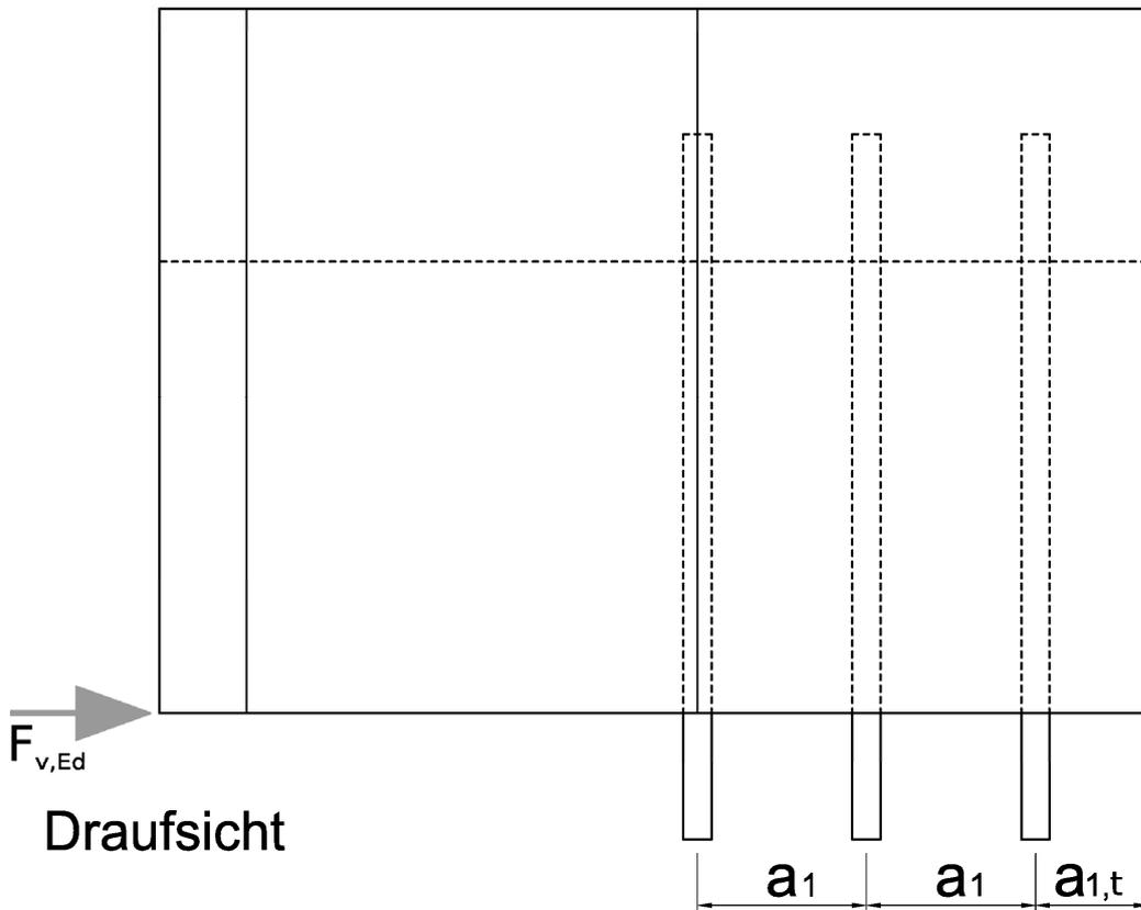
2K-EP-Klebstoff WEVOPOX 32 S mit WEVODUR B 24 TS zum Einkleben von Stahlstäben
