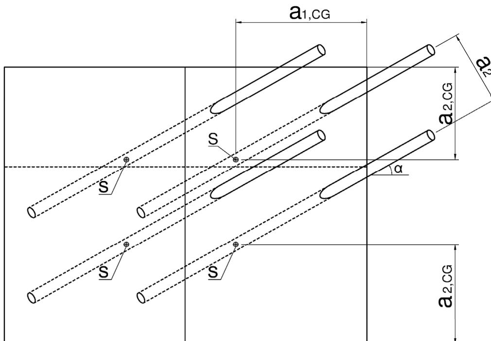
S: Schwerpunkt des im Holzbauteil eingeklebten Teiles der Stahlstäbe
